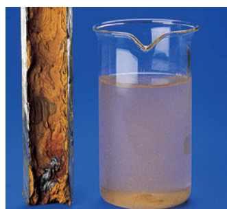
Corrosion perforante, rouille et eau brune dans un réseau non protégé.
