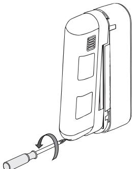
**2** Rimuovere le 2 viti di fissaggio (**b**) della base. **Non toccare gli specchi.**
