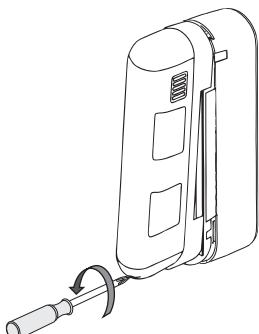
**2** Quite los 2 tornillos de fijación (b) de la base. **No toque los espejos.**
