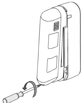
**2** Lösen Sie die 2 Befestigungsschrauben (b) des Unterteils. **Berühren Sie die Spiegel nicht.**
