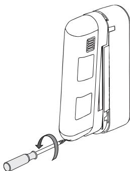
**3** Lösen Sie die 2 Befestigungsschrauben (**b**) des Unterteils. **Berühren Sie die Spiegel nicht.**
